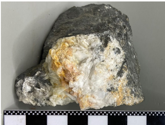
Рис. 9. Ксеноморфні виділення родохрозиту у карбонатному прожилку у вулканічній породі (Майданпек, округ Бор, Сербія). Зразок № 12419, розмір 7×6,5×3 см, маса 205,0 г.
