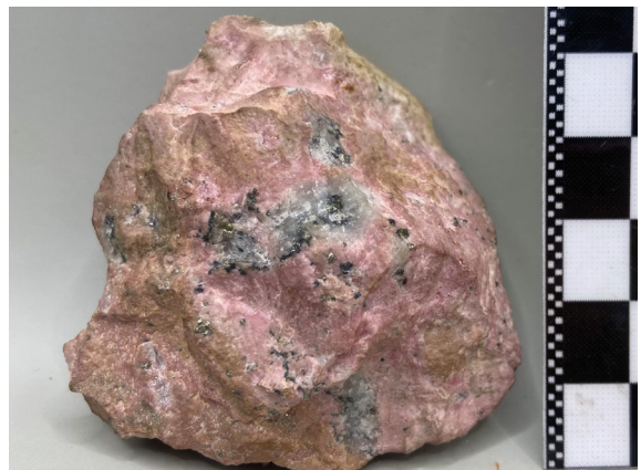
Рис. 6. Масивний агрегат родохрозиу з прожилками кварцу і вкрапленнями халькопіриту і галеніту (район Б'ютт, округ Сілвер-Бау, штат Монтана, США). Зразок №13030, розмір 6×6×2 см, маса 126,6 г.
